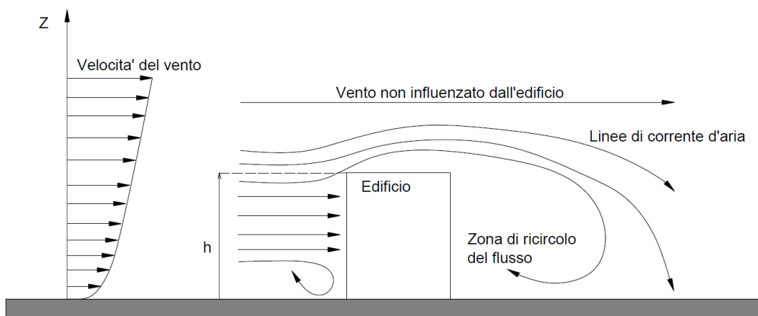
Figura 8: profilo di velocità del vento ed influenza dell'edificio.
